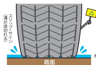
ゴム製のため経年劣化または摩耗により溝深さが減る。
